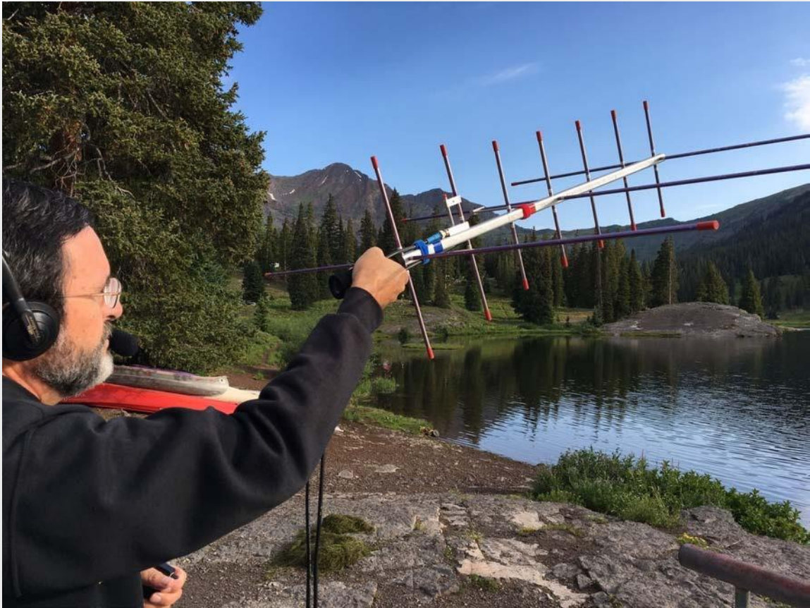
史蒂夫，N9IP将他的箭头天线指向科罗拉多州欧文湖。注意在吊杆和同轴电缆上使用红色和蓝色胶带指示VHF和UHF连接。他戴着Heil Pro Micro Dual iC耳机，左手使用Heil PTT手动开关。收音机是 Icom IC-821H,现在被 IC-9700 取代。
